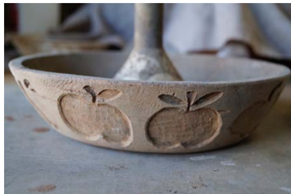
Figura 80.- Molde de apretón. Se trata de un plato con figuras de manzanas. El uso de este se realiza presionando el barro para obtener las formas de las frutas. Fotografía de Gabriela Uribe, Zinapécuaro, Michoacán (julio de 2015).
