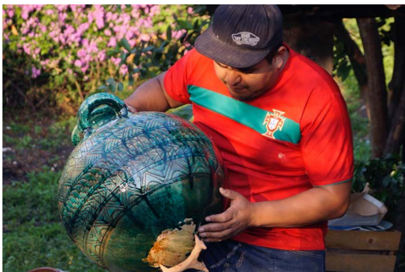
Figura 91.- Bruno –hijo del señor Salvador Hernández– extrayendo una pieza vidriada del horno. Debajo de esta se puede observar la base en que le es colocada durante la quema. Fotografía de Gabriela Uribe, Zinapécuaro, Michoacán (julio de 2015).
