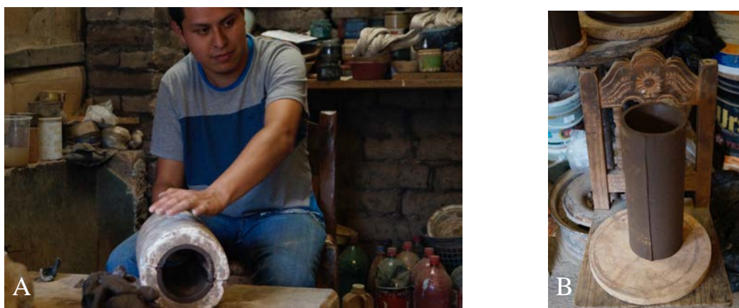
Figura 79.- Fotografía A. Joel, el hijo del señor Guadalupe, realiza una pieza con dos moldes y cuando estos son retirados –fotografía B– se ve la unión formada, lo cual es tallado con tela de mezclilla o incluso con una navaja, dependiendo del grosor de las protuberancias. Fotografía de Gabriela Uribe, Zinapécuaro, Michoacán (julio de 2015).
