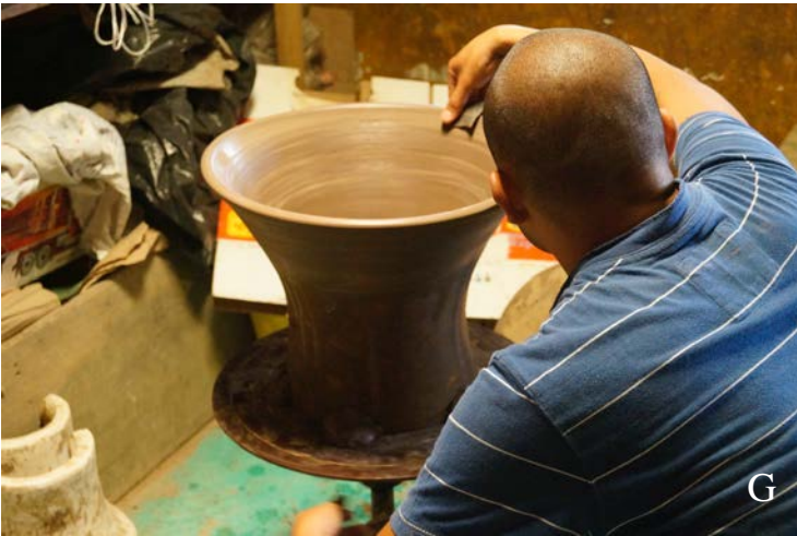
Figura 75.- Ventura, hijo del señor Salvador, utilizando la técnica de tiras de barro para realizar el borde de la pieza cerámica. Fotografía de Gabriela Uribe, Zinapécuaro, Michoacán (julio de 2015).
