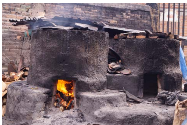
Figura 68.- En esta fotografía se muestran dos de los tres hornos que se encuentran en el taller. Éstos pueden ser divididos según su tamaño como chico y grande. Este último es usado sólo cuando se tiene una gran cantidad de piezas a quemar o son de gran formato. Fotografía de Gabriela Uribe, Zinapécuaro, Michoacán (octubre de 2014).
