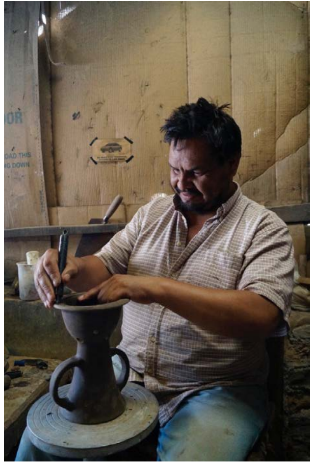
Figura 65.- El señor Guadalupe Hernández utilizando un desbastador para crear un esgrafiado en una de sus piezas. Fotografía de Gabriela Uribe, Zinapécuaro, Michoacán (julio de 2015).
