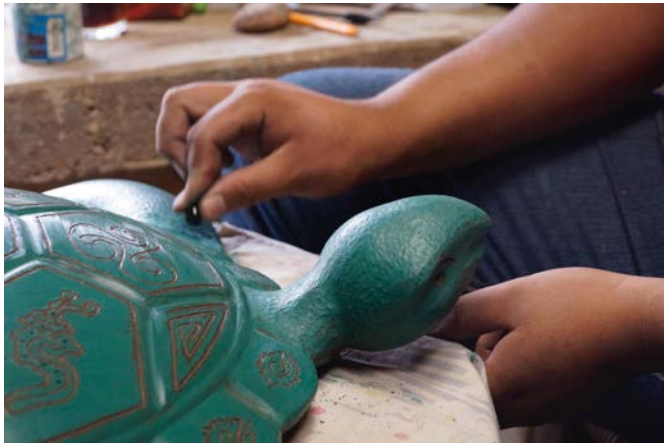
Figura 88.- Bruñido de una pieza de barro por medio de la utilización de un fragmento pequeño de cuarzo para poder tener acceso a áreas difíciles de alcanzar de la pieza cerámica. Fotografía de Gabriela Uribe, Zinapécuaro, Michoacán (junio de 2015).
