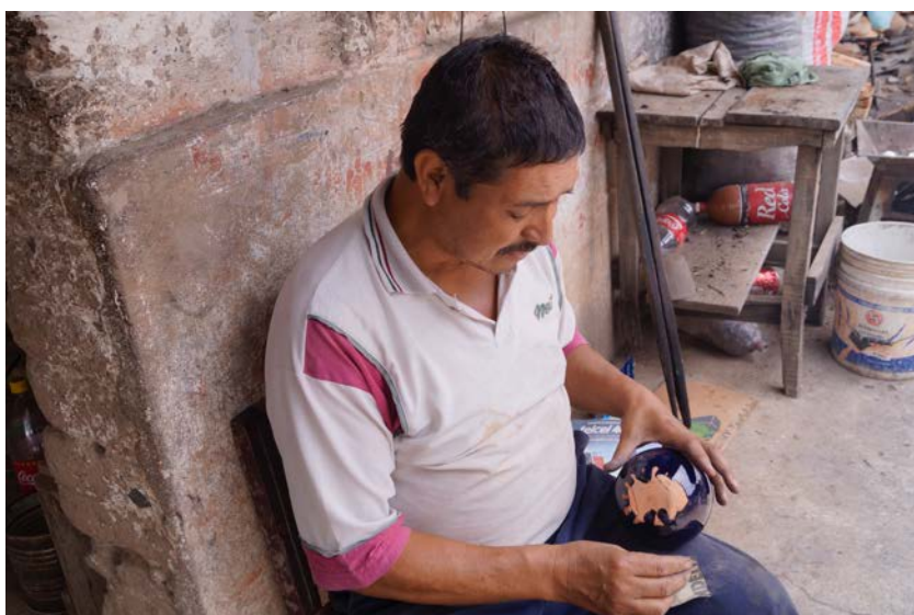
Figura 90.- El señor Salvador Hernández, quien por medio de una lija, empareja la base de la pieza cerámica vidriada para exponerla a una segunda quema. Fotografía de Gabriela Uribe, Zinapécuaro, Michoacán (julio de 2015).
