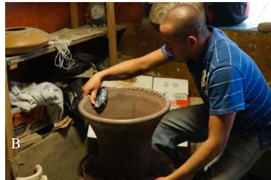
Figuras 58 y 59.- En la fotografía A se observa a la señora Feliza, esposa del señor Salvador, utilizando una piedra de río para alinear las partículas del barro y eliminar las burbujas de aire que durante la quema pueden provocar que la pieza quiebre. En la fotografía B se encuentra Ventura, el hijo del señor Salvador, utilizando un trozo de tela de mezclilla para el mismo propósito. Fotografías de Gabriela Uribe, Zinapécuaro, Michoacán (abril de 2014).
