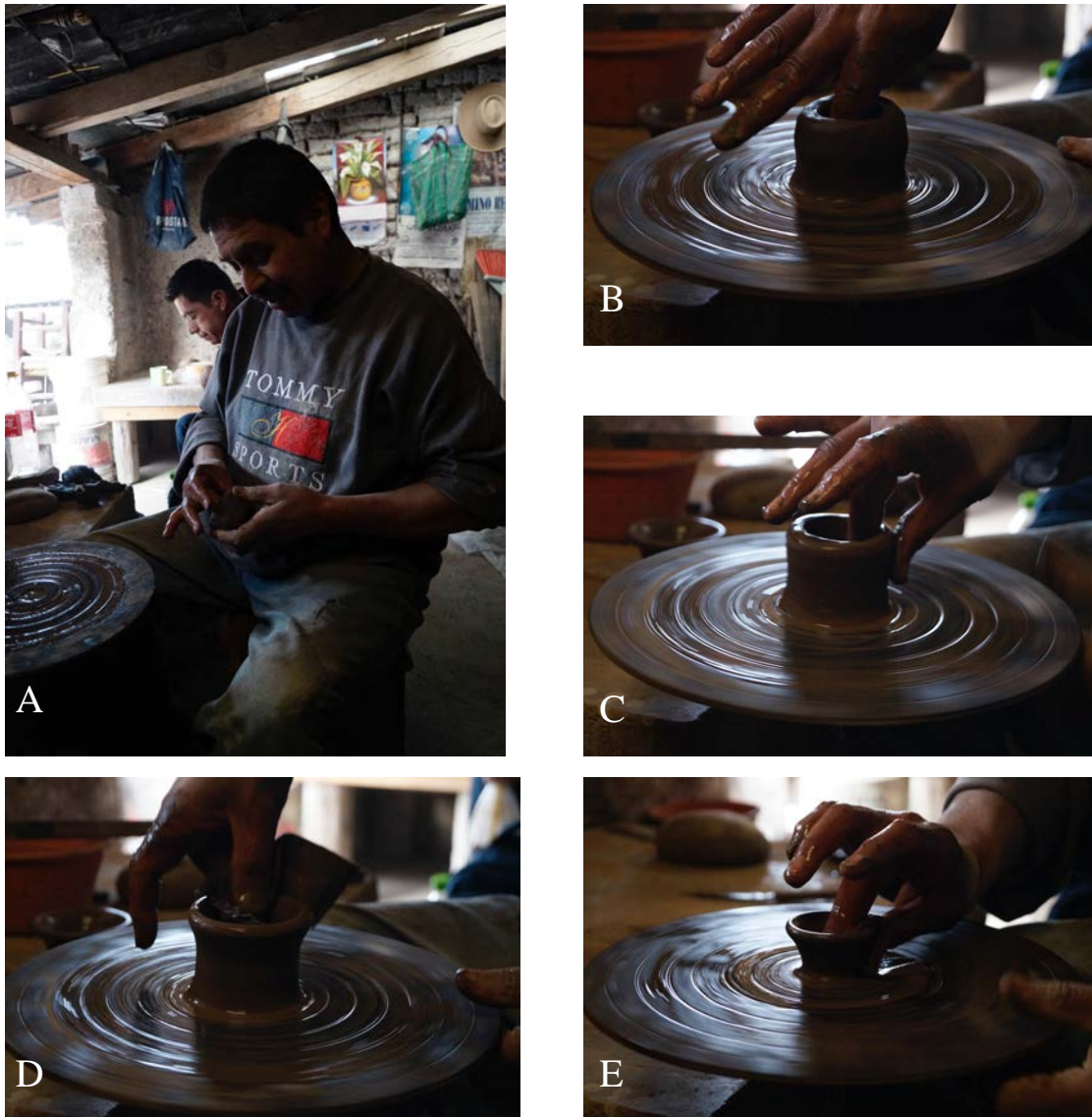
Figura 74.- El señor Salvador usando el torno para la creación de bocas para ollas. Al mismo tiempo utiliza diferentes herramientas para buscar la perfección de las mismas. El tiempo de elaboración para realizar cada una es aproximadamente de dos minutos, por lo que se observa la habilidad que presenta para realizarlas. Fotografías de Gabriela Uribe, Zinapécuaro, Michoacán (mayo de 2015).
