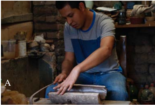
Figuras 56 y 57.- La herramienta llamada “alambre de arpa” es utilizada para cortar el barro, tanto para dividir un trozo de barro como para dar el acabado exacto a la pieza. En la fotografía A se observa a Joel y en la fotografía B se aprecia a la señora Martha, ambos miembros de la familia del señor Guadalupe, utilizando esta herramienta. Fotografías de Gabriela Uribe, Zinapécuaro, Michoacán (julio de 2014).
