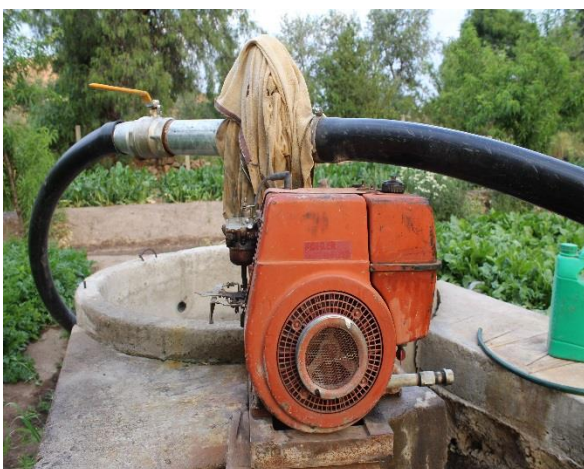
3°. Motobomba de gasolina
