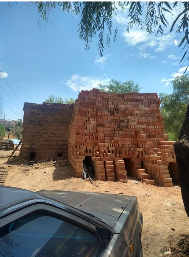
Fotografía 4. Horno tipo campaña, comunidad de Yerbabuena, Guanajuato. Fotografía Lic. Joaquín Alberto Valenciano Reyes (trabajo de campo, julio 1° del 2022)
