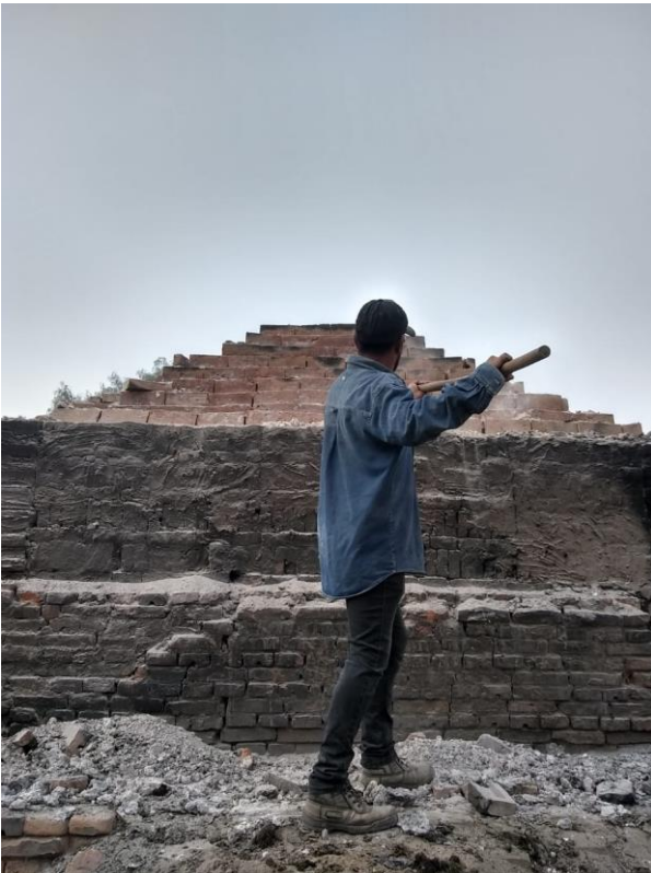
Fotografía 19. Volteando ladrillos cocidos para dejarlos enfriar. 09 de mayo del 2021. Fotografía Lic. Joaquín Valenciano Reyes (trabajo de campo)
