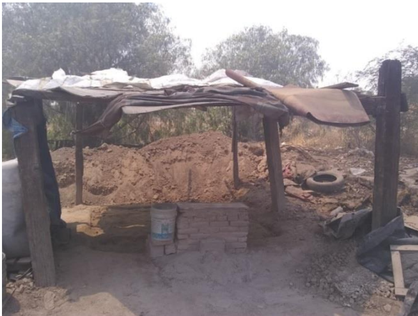
Fotografía 12. Banco donde se realiza el batido, detrás del mismo se ubican tanto la tierra “chiclosa” y “arenosa”, en el pequeño montico de la parte de enfrente se coloca el molde y la tierra blanquizca es tierra “tizar”. 09 de mayo del 2021. Fotografía Lic. Joaquín Valenciano Reyes (trabajo de campo)
