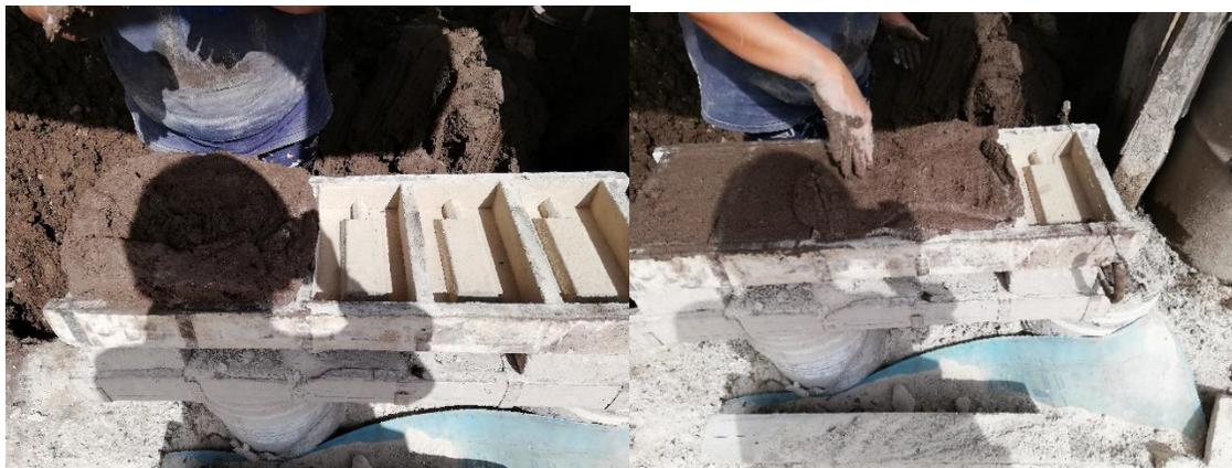
Frente al batidero, los ladrilleros vacían de un tirón los moldes volteándolos sobre el pavimento o espacio dispuesto para el tendido, forman filas de ladrillos crudos, grises y húmedos. Estas etapas pueden durar entre 3 y 4 horas, y la cantidad de ladrillos que se logren hacer dependen de la pericia de los trabajadores, de las ganas y la experiencia que tengan
