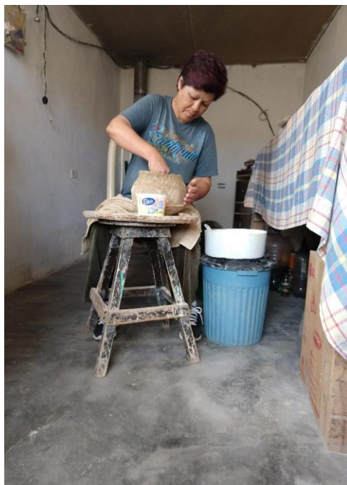
FIGURA 21. PATRICIA ORTIZ HACIENDO UNA OLLA DE BARRO “MARMOLEADO” SOBRE MOLDE DE YESO. EL MARMOLEADO ES UNA MEZCLA ENTRE DOS O MÁS BARROS DE DISTINTOS COLORES FORMANDO UN SOLO ENGOBE. DE TAL FORMA, SE CREA UN EFECTO VETEADO. FOTOGRAFÍA DE CARMEN GRAJEDA, JUAN MATA ORTIZ, CHIHUAHUA, MAYO DE 2019.
